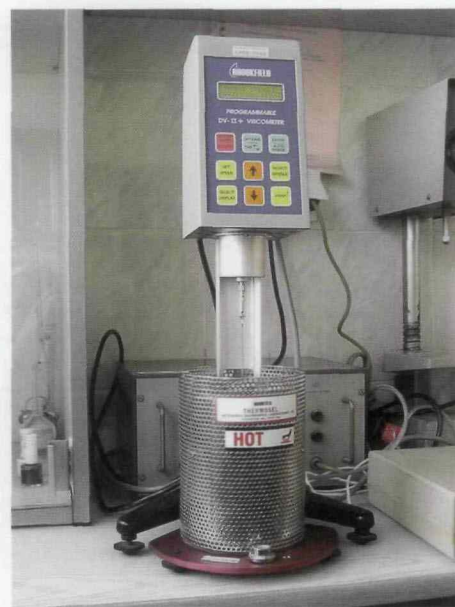
Fot. 1. Lepkościomierz rotacyjny Brookfield wraz z systemem Thermosel, utrzymującym żądaną temperaturę badania
